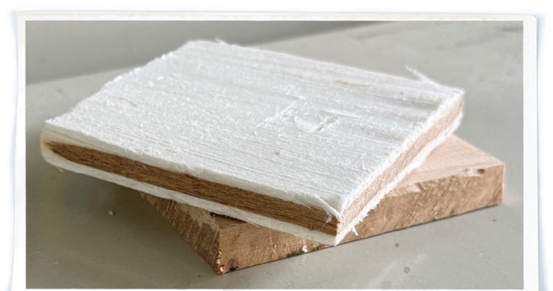
Bois de peuplier modifié (haut) développé dans le cadre du projet, comparé au bois de peuplier naturel (bas).
