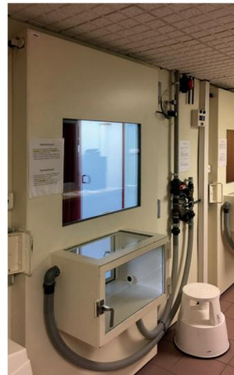
Portes d'entrées des chambres calorimétriques où les volontaires séjournent de 36 à 48 heures pour mesurer les dépenses énergétiques.
